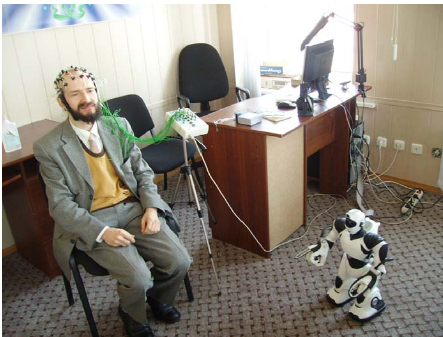
Рис. 7.1. Интерфейс ЭЭГ мозга человека – компьютер, разработанный Я.И.Корчмарюком и А.К.Трухиным
