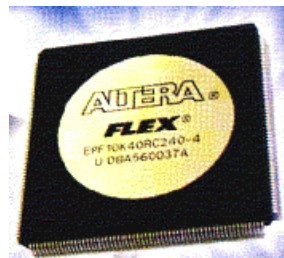
Рис. 4.3. Нейрочип нейрокомпьютера «ЭМБРИОН-10», разработанный С.К.Шарифовым
