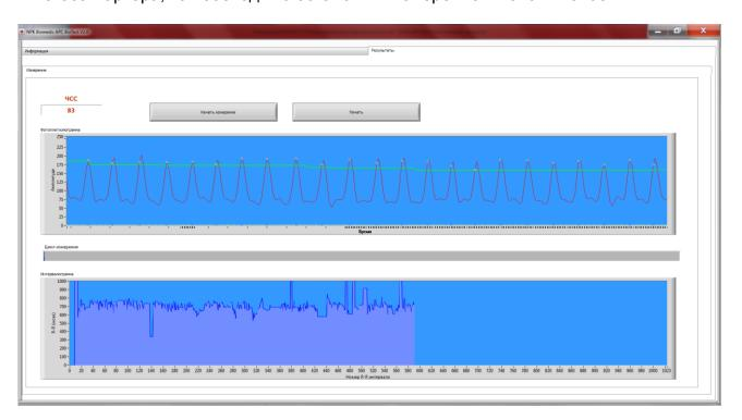
После стабилизации сигнала нажмите на кнопку «Начать измерение». Для набора необходимых данных для дальнейшего анализа программе необходимо 240 циклов измерения. Отсчет циклов отображается на индикаторе «Циклизмерения» на вкладке «Измерение».
